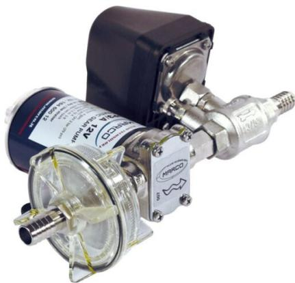
Самовсасывающие электронасосы с геликоидальными шестернями из PTFE оснащены прямооточным фильтром, реле давления, обратным клапаном, для использования в качестве автоматических насосов. Корпус из никелированной латуни, вал из нержавеющей стали, уплотнения из FKM и O-кольца из NBR. Выпускаются в версии со встроенным расширительным баком.
