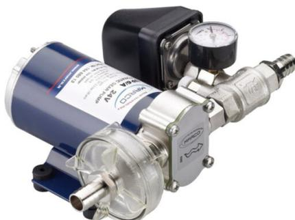
Самовсасывающие электронасосы с геликоидальными шестернями из PTFE оснащены прямоточным фильтром, реле давления, обратным клапаном, для использования в качестве автоматических насосов. Корпус из никелированной латуни, вал из нержавеющей стали, уплотнения из FKM и O-кольца из NBR. Выпускаются в версии со встроенным расширительным баком.
