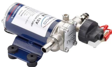
Самовсасывающие электронасосы с геликоидальными шестернями из PTFE оснащены прямооточным фильтром, реле давления, обратным клапаном, для использования в качестве автоматических насосов. Корпус из никелированной латуни, вал из нержавеющей стали, уплотнения из FKM и O-кольца из NBR. Выпускаются в версии со встроенным расширительным баком.
