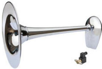
Одобренный свисток в комплекте с хромированным или белым рупором Ø300 мм. Электрический клапан и монтажные принадлежности для работы со сжатым воздухом 6/12 бар. Соответствует требованиям МППСС 1972 г. IMO класса III. Одобрения: RINA, LLOYD'S REGISTER MCA, BUREAU VERITAS, BSH и NMMA.
