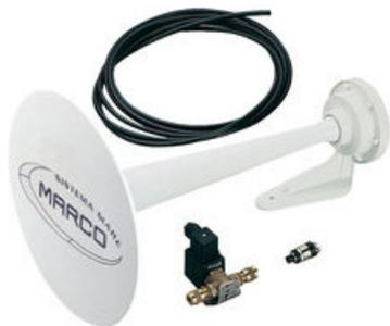
Одобренный свисток в комплекте с хромированным или белым рожком Ø 300 мм. Электрический клапан и монтажные принадлежности для работы со сжатым воздухом 6/12 бар. Соответствует требованиям МППСС 1972 г. IMO класса III. Одобрения: RINA, LLOYD'S REGISTER MCA, BUREAU VERITAS, BSH и NMMA.
