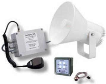
Одобренный электронный свисток в комплекте с динамиком, встроенной мембранной панелью управления и электронным контроллером. Новая система ультразвукового нагрева для улучшения характеристик акустической мембраны. Соответствует международным нормам COLREG 1972 IMO класса IV с омологацией RINA, LLOYD'S REGISTER MCA, BUREAU VERITAS, NMMA и BSH. В комплекте монтажный комплект.
